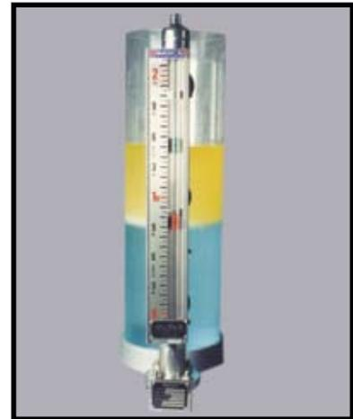
**Interfase:** En aplicaciones donde un recipiente contiene 2 líquidos de diferente densidad (diferencia min. De 0.1 S.G.); el indicador LG tiene 2 flotadores y 2 indicadores
