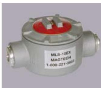
El MLS-10EX-C es un interruptor DPDT usado para el control de bombas, solenoides, etc. Puede ser fijado por el usuario para ser activado por niveles ascendentes o descendentes. El 10EX-C cumple con los códigos Clase 1, Div. 1 y tiene aprobación UL. Están disponibles interruptores para altas cargas inductivas.
