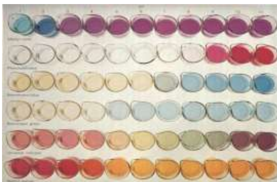
Gambar 2. Beberapa macam larutan indikator asam basa dengan warna-warnanya pada derajat keasaman 1 sampai 11
